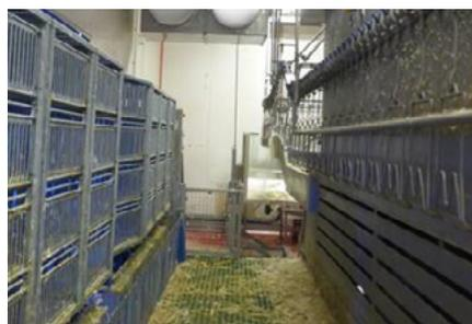
Caissons aspirants au niveau d'un poste d'accrochage des volailles
