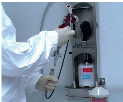
Dispositif de nettoyage des pistolets © Fillon Technologies
